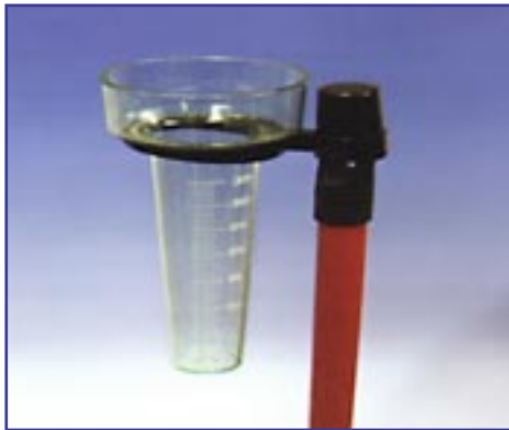
Slika 7: Preprost dežemer, s katerim lahko sledimo, koliko dežja je padlo na nekem območju.
