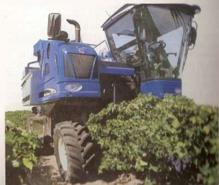
Vendemmiatrice polivalente ad alta capacità New Holland.
