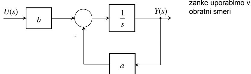
Dobljena blokovna shema je ekvivalentna simulacijski shemi za sistem 1. reda
