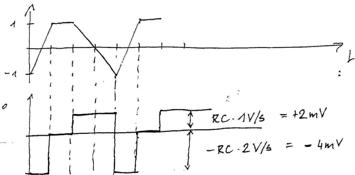
$$t=0 \rightarrow 1 : \quad u_o = -RC \cdot \frac{\Delta u_i}{\Delta t} = -RC \cdot 2 \text{ V/s}$$
