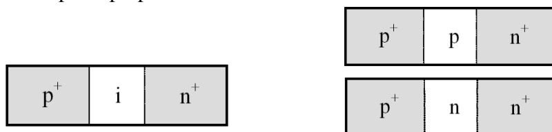
Slika: Notranja struktura visokonapetostnih diod
