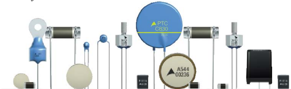
Slika 11: Tipične izvedbe NTK in PTK uporov
