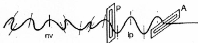
**Polarizacija v mehaniki:** Nepolarizirano (nv) in linearno polarizirano (lp) valovanje na prožni vrvici. P polarizator, A analizator. Za analitatorjem ni valovanja. Daljice kažejo smer gibanja delov vrvice. (J. Strnad, Fizika II)
