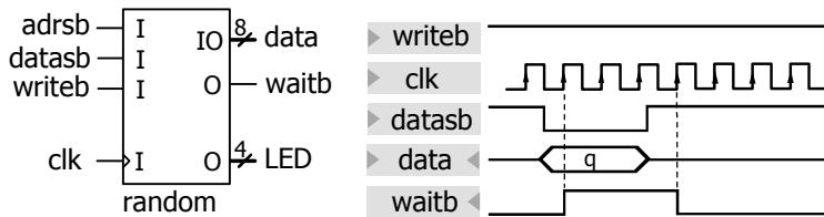
Naredi testno strukturo za simulacijo delovanja generatorja psevdonaključnih vrednosti z EPP vmesnikom. Uporabi čarovnik za izdelavo testnih struktur v okolju Xilinx Project Navigator (Project > New Source > VHDL Test Bench).
