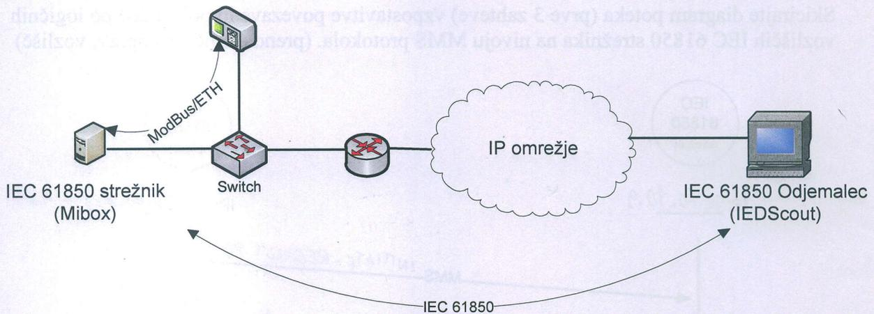
1. S pomočjo programa IEDScout se povežite z IEC 61850 strežnikom, ki virtualizira merilni števec IskraMIS MC760. Nastavite IP strežnika in izvedite poizvedovanje (*Discover*). Aplikacija IEC 61850 strežnika se izvaja na napravi Mibox. IP
