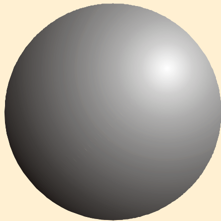
silicijev monokristal v obliki krogle s premerom 10 cm (= okoli 1kg)
