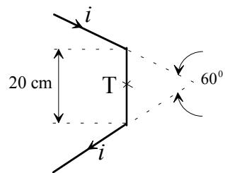
2. Vzporedno z dolgim navpičnim strelovodom je v dolžini 3 m ploščat antenski kabel. V strelovodu je ob udaru strele tok s strmino čela 40 kA/μs. Kolikšna napetost se inducira v antenskem kablu na tem delu ob udaru strele? v točki T? ( $\mu = \mu_0$ ).
