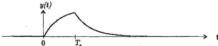
Slika 5.4 – Potek signala na izhodu sita.
