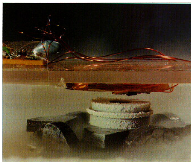
Slika 4.7.9 Uležajenje rotorja motorja s pomočjo superprevodnika
