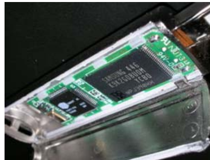
pomnilnik Flash K9K2068 (Samsung, vezje na desni) v pomnilniški enoti USB
