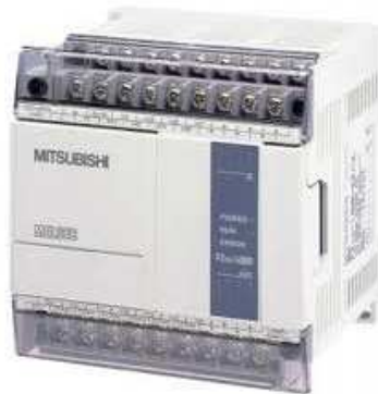
Slika 6.5: Primer kompaktnega PLK-ja (Mitsubishi serija FX)
