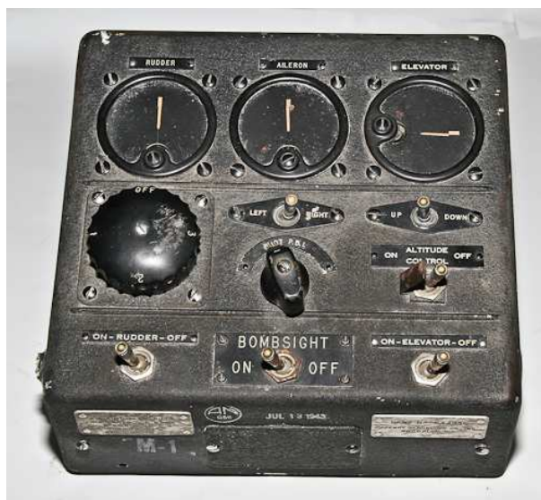
Slika 6.3: Prvi elektronski avtopilot Sperry A-5
