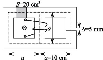
3. Trikotno oblikovana žica enakomerno rotira s krožno frekvenco  $\omega = 250 \text{ rad/s}$  v homogenem magnetnem polju gostote  $B = 100 \text{ mT}$ ; smer magnetnega polja je pravokotna na os vrtenja. Med koncema žice je priklopljeno breme, ki je sestavljeno iz zaporedne vezave upora upornosti  $R = 20 \Omega$  in kondenzatorja kapacitivnosti  $C = 400 \mu\text{F}$ . Izračunajte delovno moč, če zanemarimo upornost žice in pojav samoindukcije!
