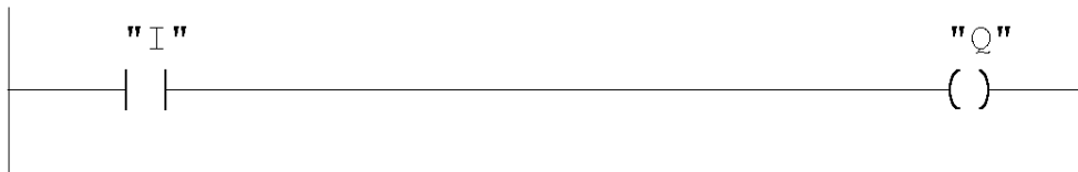
Slika 3.3: Simbol za identiteto z relejnimi elementi
