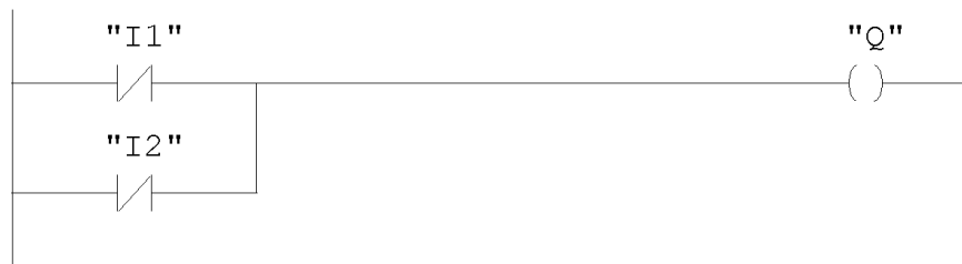
Slika 3.25: Realizacija logične funkcije NE-IN s pnevmatskimi elementi
