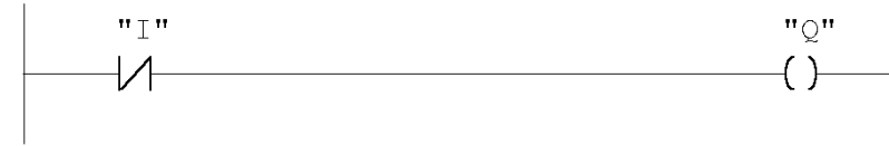
Slika 3.8: Simbolična relejna shema za logično negacijo
