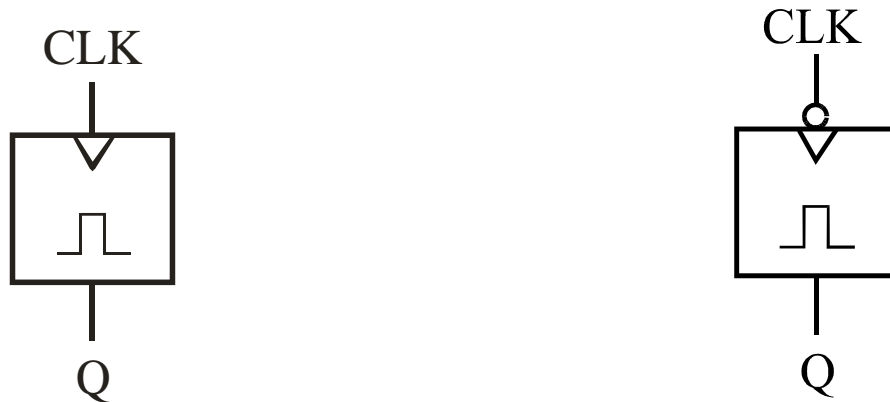
Slika 3.42: Dodatna simbola za dinamični funkciji za ugotavljanje naraščajoče (levo) in padajoče stranice
