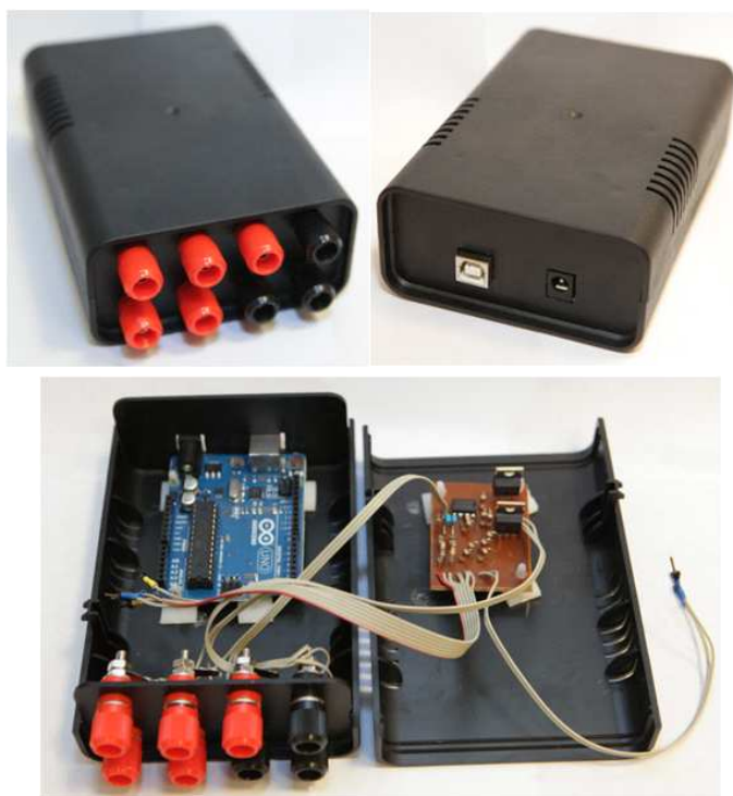
Slika 1.4: Mikrokrmilnik Arduino Uno s prilagoditvenim vezjem
