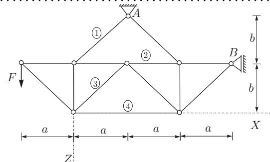
4. S principom virtualnega dela za konstrukcijo na sliki izrazite reakcije v podporah in notranji moment v točki C –  $M_C$ ! (20%)
