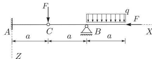
3. Za konstrukcijo na sliki izračunajte stopnjo statične nedoločenosti, reakcije in notranje statične količine ( $N_x, N_z, M_y$ )! Rezultate notranjih statičnih količin prikažite z diagrami! (55%)
