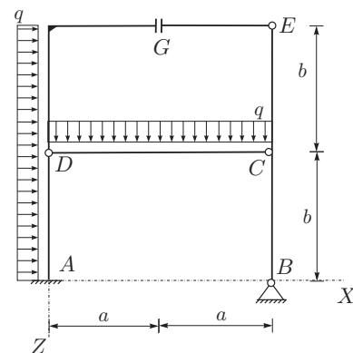
4. S principom virtualnega dela za konstrukcijo na sliki izrazite reakcije v podpori B in notranji moment v točki D! (15%)
