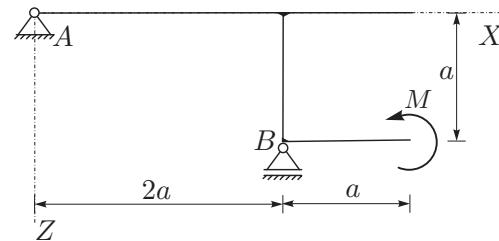
2. OBVEZNA NALOGA Za konstrukcijo na sliki izračunajte reakcije, **sile v vezi C (s kontrolo)** in notranje statične količine ( $N_x, N_z, M_y$ )! Rezultate notranjih statičnih količin prikažite z diagrami! (15%)
