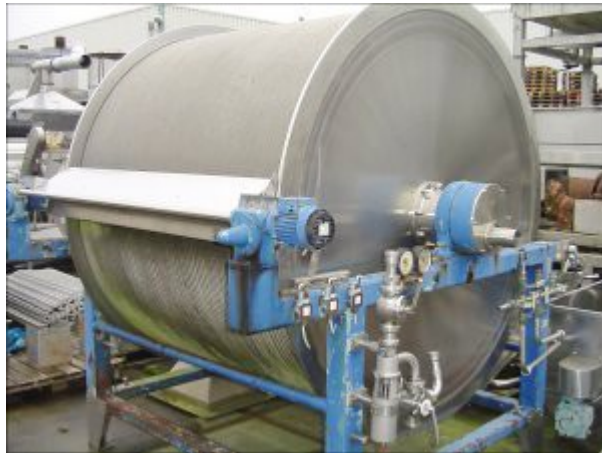
rotacijski vakuumski filter (rotating drum vacuum filter)
