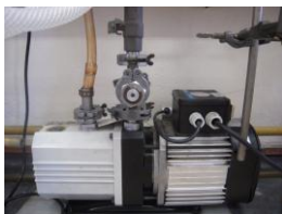
rotacijska črpalka - zmanjšanje tlaka do 10^{-3} mbar = 0,1 Pa
