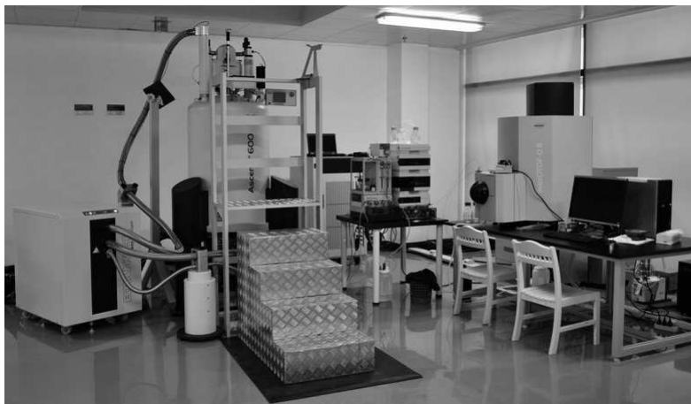
Moderni LC-SPE-NMR/MS inštrument proizvajalca Bruker.
