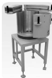
Detektor v Pb ščitju za odstranitev \gamma -žarkov iz ozadja.
