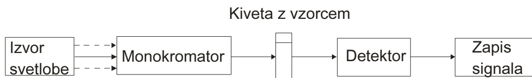
Slika 9: Shema enožarkovnega spektrofotometra
