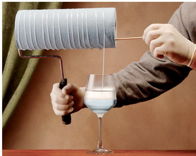
Slika: Medfazna polimerizacija pri sintezi poliamida
