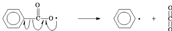
Slika: Disociacija iniciatorjev, ki razpadejo pri povišani temperaturi: 2,2'-azo-bis-izobutironitril (zgoraj) in dibenzoil peroksid (spodaj)
