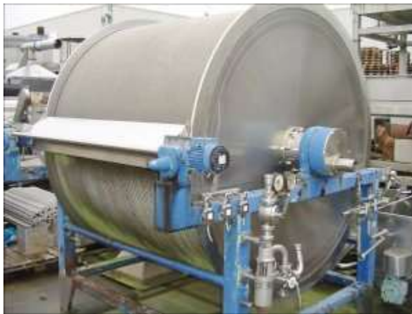
rotacijski vakuumski filter (rotating drum vacuum filter)
