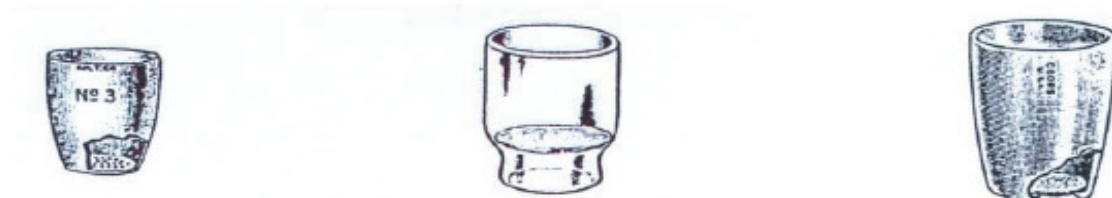
Slika 1. Različni filtrirni lončki z leve proti desni: lonček po Goochu, stekleni in porcelanasti lonček
