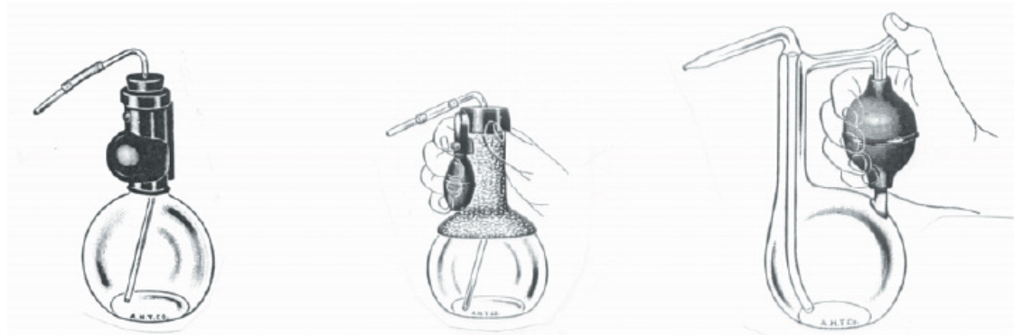
Slika 14. Puhalke za vročo prečiščeno vodo
