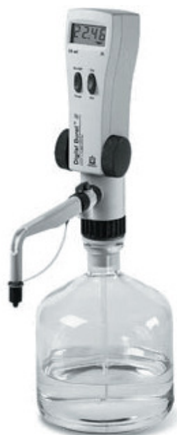
Slika 13. Bireta z digitalnim prikazom in avtomatski titrator
