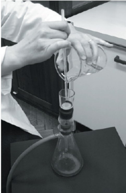
Slika 6. Pravilno prenašanje raztopine in oborine v filtrirni lonček
