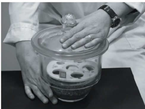
Slika 4. Pravilno odpiranje eksikatorja
