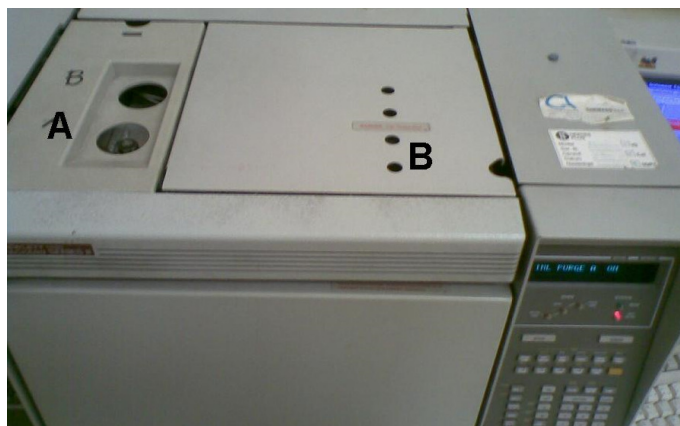
Slika 4. Plinski kromatograf Hewlett Packard HP 5890 Series II GC z oznakama položaja injektorja (A) in plamenskoionizacijskega detektorja (B).
