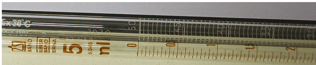
Slika 10. Merilni pipeti kapacitete 5 mL: pipeta z oznako volumna 5 mL na vrhu skale (zgoraj) in pipeta z oznako volumna 0 mL na vrhu skale (spodaj)
