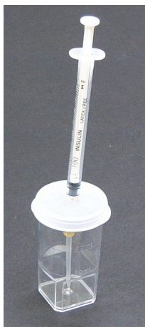
Slika 3. Pripomoček za poenostavljeno izvedbo titracije
