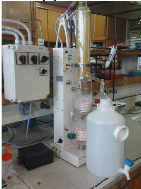
Slika 2. Sistem za pripravo dvakrat destilirane vode, ki kot izvorno vodo uporablja dvakrat deionizirano vodo (fotografija J. Reščič)
