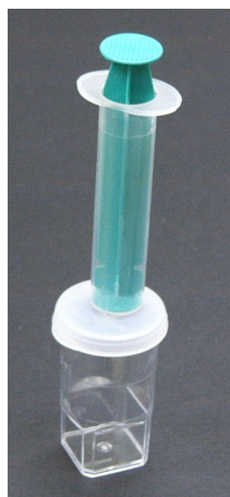
Slika 5. Pripomoček za razplinjanje vode
