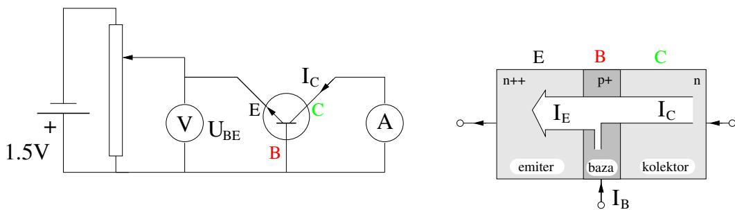
Slika 1: Shema meritve tokovno-napetostne karakteristike n-p-n tranzistorja. Z baterijo preko nastavljenega upora določimo napetost med bazo in emitorjem npn tranzistorja in merimo kolektorski tok. Barvne oznake priključkov tranzistorja so: E - črna, B - rdeča in C - zelena.
