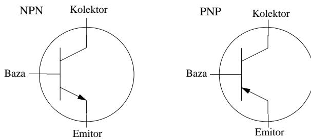
Slika 2: Elektrotehnična oznaka za npn in pnp tranzistor.
