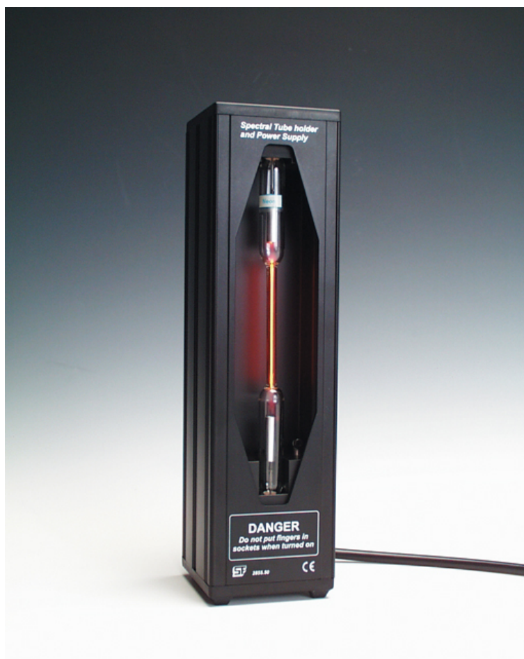
Slika 9.5.: Nosilec za ampule s plinom, ki je kombiniran s samo-reguliranim izvirom visoke enosmerne napetosti do 6 kV in tokovi do 2 mA. Ampule plina so pri nizkem tlaku med 10 do 100 Pa.
