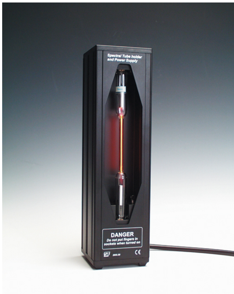
Slika 5: Nosilec za ampule s plinom, ki je kombiniran s samo-reguliranim izvorom visoke energetske napetosti do 6 kV in tokovi do 2 mA. Ampule plina so pri nizkem tlaku med 10 do 100 Pa.
