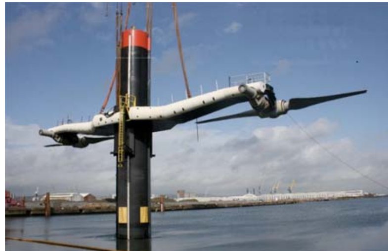
Pretočna plimska HE podjetja Marine Current Turbines pri projektu Sea Gen (GB)
