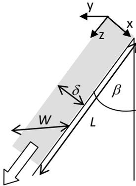
Po ravni plošči širine  $W$ , nagnjeni pod kotom  $\beta$  (glej sliko) teče navzdol film kapljevine s konstantno debelino  $\delta$ . Predpostavimo, da je tok tekočine nestisljiv, laminaren, stacionaren, polnorazvit in dvodimenzionalen.
