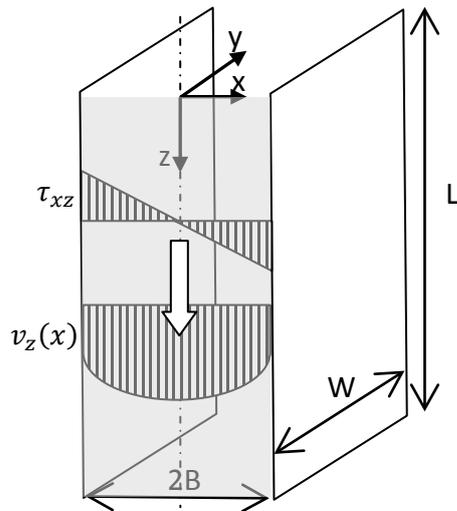
Obravnavamo navpični, navzdol usmerjeni, laminarni, stacionarni, polnorazvit, dvodimenzionalen tok nestisljive tekočine med dvema vzporednima ploščama širine  $W$ , ki sta razmaknjeni za  $2B$ . Tok je simetričen glede na ravnino  $x=0$ .
