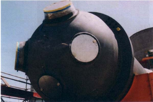
Pogled na spodnji del uparjalnika
