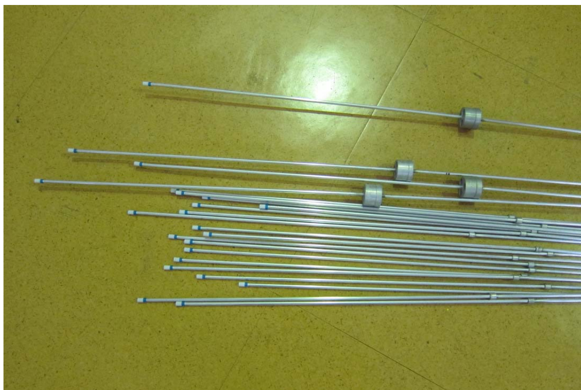
Slika 3: Spodnji del cevi za dovajanje mehurčkov.
