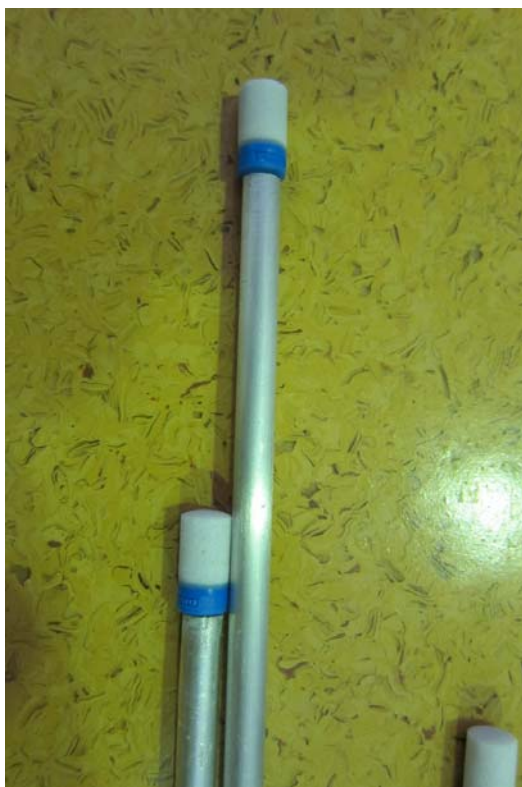
Slika 2: plastičen dušilec (FESTO) za proizvodnjanje drobnih zračnih mehurčkov.
