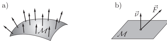
Slika 5.11: a) Orientirana ploskev \mathcal{M} , b) Pretok vektorskega polja \vec{F} skozi \mathcal{M} v smeri \vec{\nu}
