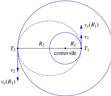
V krožni orbiti s polmerom  $R_1$  je hitrost točke enaka:  $v_1^2 = \frac{\gamma}{mR_1}$ . Če jo hočemo utiriti v eliptično orbito z apsidnima razdaljama  $R_1$  in  $R_2$ , jo moramo v obodni smeri pospešiti do hitrosti
