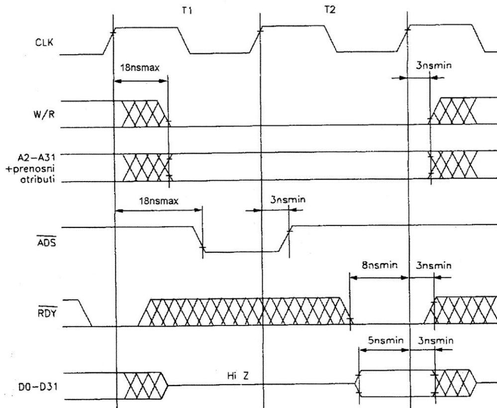
4. Procesor z dolžino besede 8 bitov ima preko 32-bitnega podatkovnega vodila priključen SDRAM. SDRAM krmilnik naslovne signale procesorja preslika v signale SDRAM-a po spodnji sliki. Procesor zaporedoma bere 32 bitne podatke. Upoštevajte, da je SDRAM že nastavljen v ustrezen način delovanja, ni pa bil opravljen še noben bralni ali pisalni dostop.
