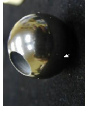
(b) Luknja v kroglji iz silicijevega nitrida
