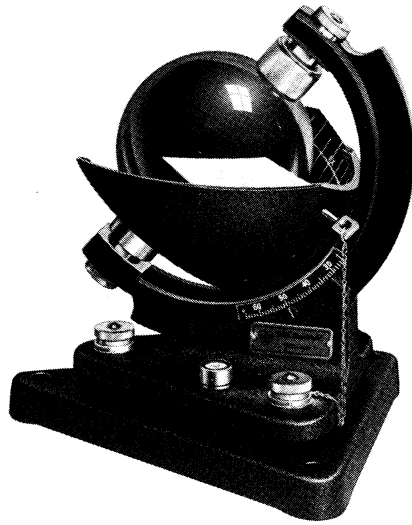
Slika 1.10: Heliograf je optična naprava za merjenje trajanja sončnega obsevanja. Sončni žarki se zberejo v krogelni leči in v njenem gorišču izžigajo registrirni trak.
