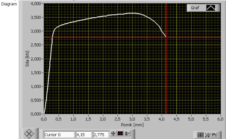
Izmerjene lastnosti:  $d_0 = 4 \text{ mm}$ ;  $d_u = 3 \text{ mm}$ ;  $F_{\max} = 3,65 \text{ kN}$ ;  $F_u = 2,8 \text{ kN}$ ;  $\Delta l_u = 3,8 \text{ mm}$ ,  $l_0 = 20 \text{ mm}$ . Izračunani značilni podatki:
