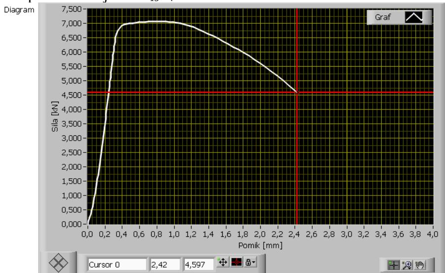
Izmerjene lastnosti:  $d_0 = 4 \text{ mm}$ ;  $d_u = 2,7 \text{ mm}$ ;  $F_{\max} = 6,7 \text{ kN}$ ;  $F_u = 4,1 \text{ kN}$ ;  $\Delta l_u = 2,35 \text{ mm}$   $l_0 = 20 \text{ mm}$ . Izračunani značilni podatki:
