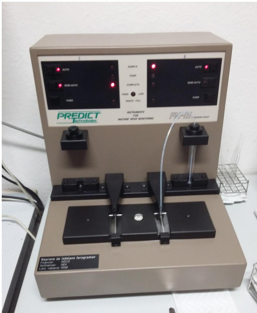
Slika 1: Naprava za izdelavo ferogramov
