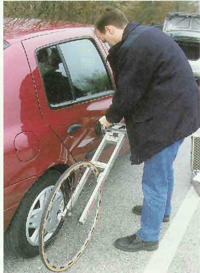
Merilno kolo se prisesa na bok avtomobila.
