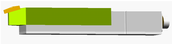
Slika 3: Rezalno orodje in senzor rezalnih sil
