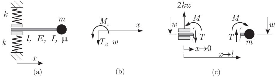
Lastne frekvence nosilca s sl. (a) so odvisne od lastnosti nosilca samega (podano z izrazom  $W(x)$ ) kot tudi od *robnih pogojev*. Za potrebe pravilnega zapisa robnih pogojev moramo ustrezno določiti notranje veličine nosilca na robovih, *notranje prečne sile*  $T$  in *notranje momente*  $M$ , sl. (c) (na sl. (b) je označen tudi koordinatni sistem s pozitivno usmerjenimi *zunanjimi* veličinami,  $T_z$  in  $M_z$ ; glej tudi predavanja in vaje). V skladu s sl. (a) in (c) so robni pogoji
