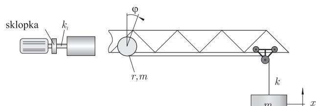
Za primer, ko elektromotor navijalnega sistema žerjava miruje, sistemu breme – navijalni boben določite *modalno togostno matriko*. Breme ima maso  $m_b$ , boben ima maso  $m$ , polmer  $r$ , in je z elektromotorjem povezan preko gredi togosti  $k_t$ , boben in breme pa sta med seboj povezana s pletenico togosti  $k$ . *Namig:* ne pozabite na torzijsko vzmet  $k_t$  in na to, da se sila teže bremena izenači s statičnim raztezkom pletenice in torzijske vzmeti.
