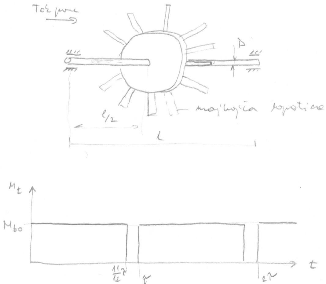
Slika 1: Shema turbine in diagram poteka torzijskega momenta, ki ga turbina generira.
